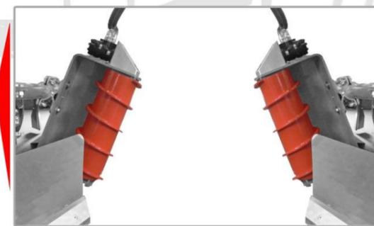
Dos **còcleas giratorias**, accionadas por **motores hidráulicos**, realizan las
